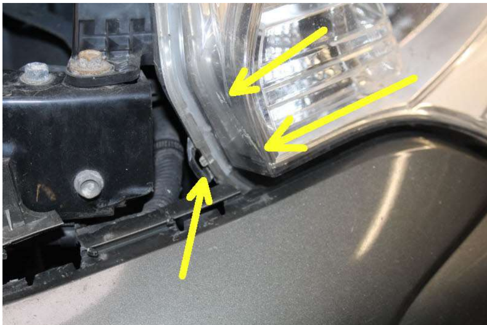
Bild 20 Scheinwerfer vorn links verkratzt
