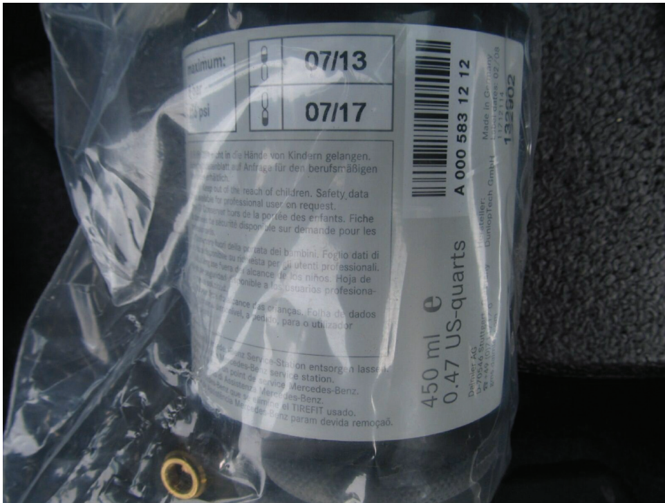
Bild 11 : Dichtmittel: Haltbarkeitsfrist abgelaufen
