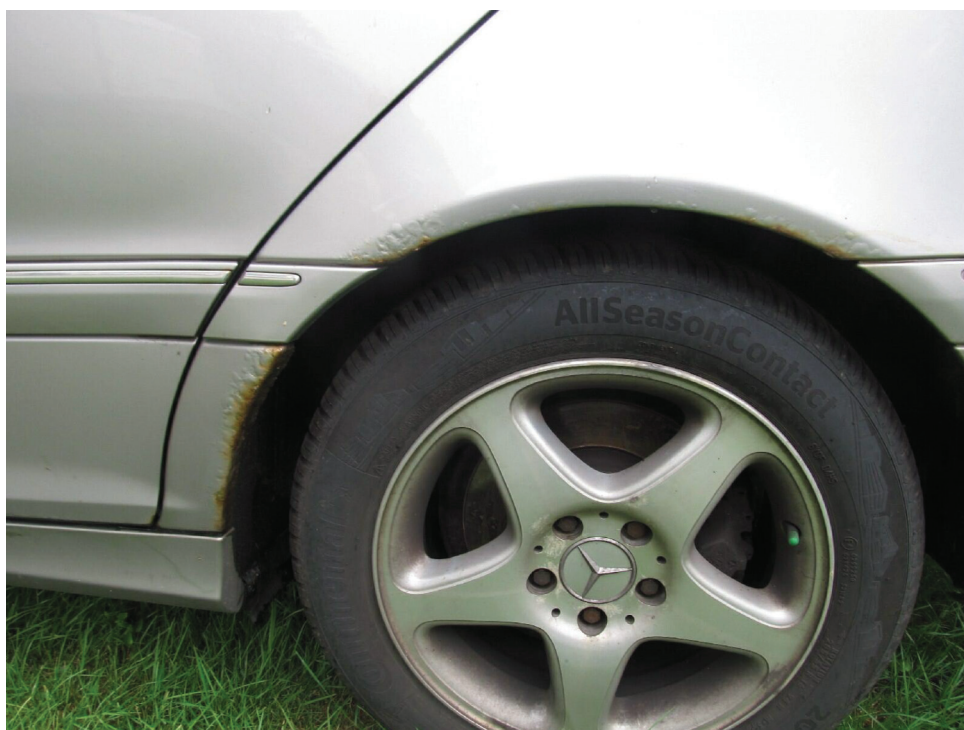
Bild 8 : Radlauf hinten links durchgerostet
