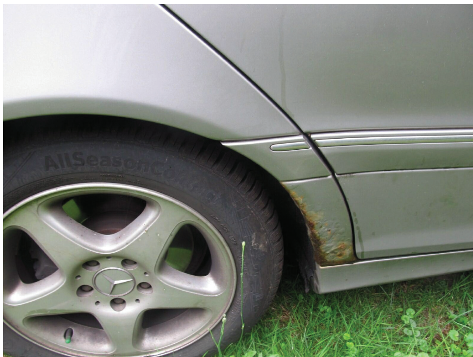
Bild 9 : Radlauf hinten rechts durchgerostet
