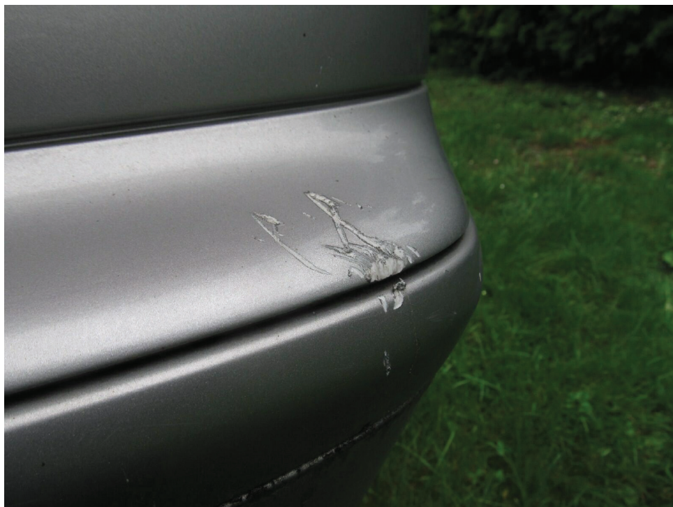
Bild 10 : Stoßfängerabdeckung hinten rechts verschrammt
