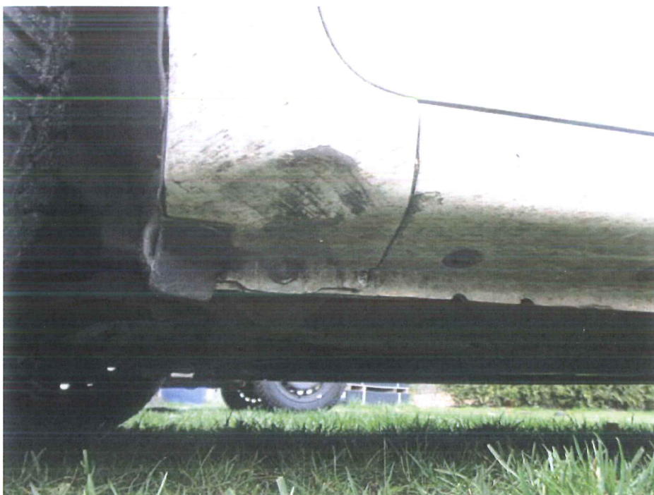
Bild 10 : Kotflügel / Schweller vorn links hochgedrückt
