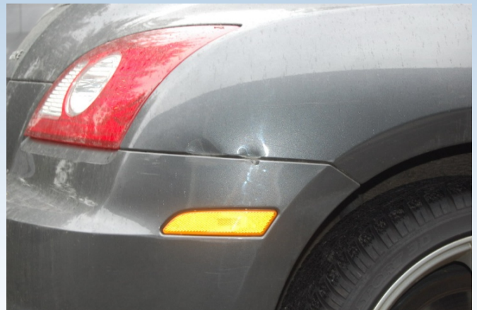
Schaden Kotflügel hinten rechts
